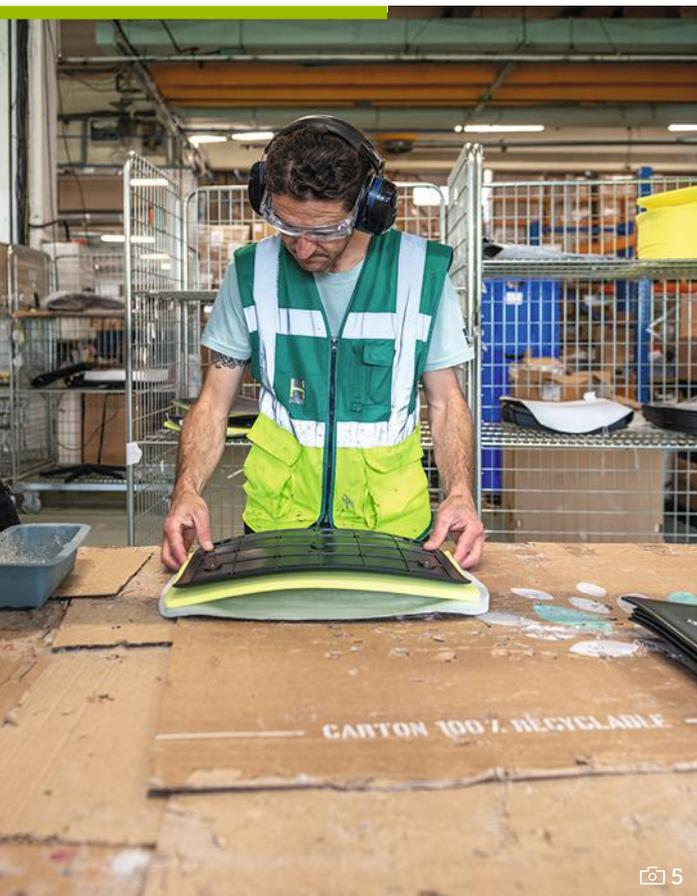
📷 5. **COLLAGE DES MOUSSES** de sièges. Après de nombreux essais, la colle précédemment utilisée qui dégageait des composés organiques volatils a été remplacée par un pain de colle que l'on chauffe à basse température et qui est exempt de CMR.
