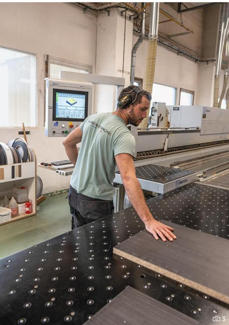
📷 3. **LES MACHINES** de l'atelier bois bénéficient de l'aspiration à la source, asservie à un système centralisé. Les tables équipées de microbilles facilitent les déplacements sans rayer les panneaux. Partout, un éclairage naturel permet d'avoir une vue sur l'extérieur.
